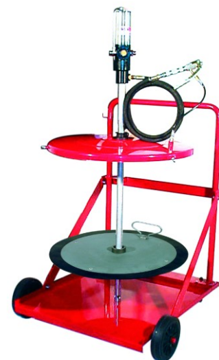
Art. 519 Con coperchio, premigrasso, carrello, tubo di uscita (3 mt) e pistola
