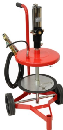
Art. 517, 518 Con coperchio, premigrasso, carrello, tubo di uscita (3 mt) e pistola
